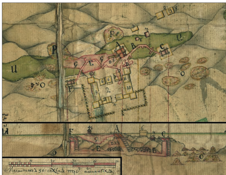
Рис. 3. План и разрез Комисской, Западной и Восточной шахт. Фрагмент чертежа 1749 г.
