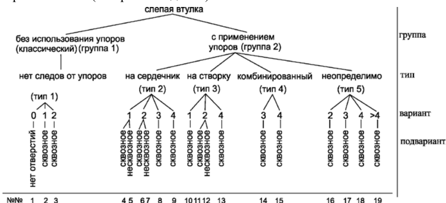
Рис. 1. Классификация способов изготовления полой втулки тагарских кельтов
